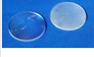
Eine der beiden Linsen soll unsere Mattscheibe werden. Dazu schleifen wir die plane Seite mit [800er Schleifpulver](#) (Siliziumkarbid 100g 3,50€), bis diese schön gleichmäßig milchig ist.
